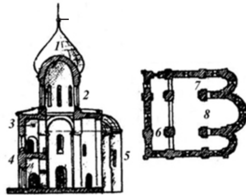
Схема крестово-купольной конструкции однокупольного древнерусского храма: 1 – купол, 2 – барабан, 3 – закомара, 4 – хоры, 5 – апсида, 6 – столб, 7 – боковой неф, 8 – центральный неф
